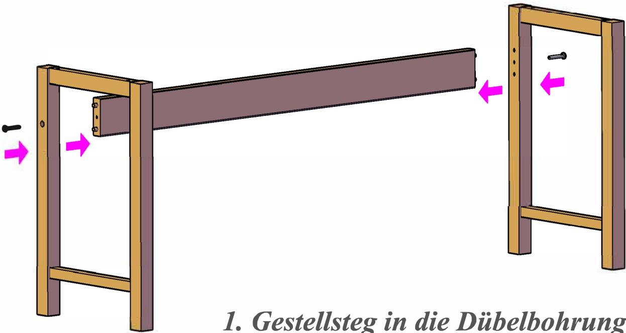
*1. Gestellsteg in die Dübelbohrungen der beiden Gestellrahmen stecken und jeweils mit einer Flachrundschaube M6x50 verschrauben*
